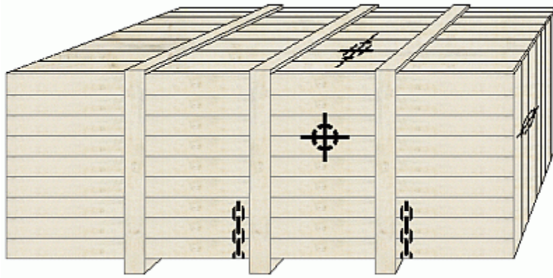
Anbringung des Schwerpunktzeichens an drei Seiten gemäß DIN-Blatt
